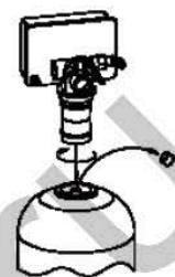
Удалить заглушку, закрепить вентиль
